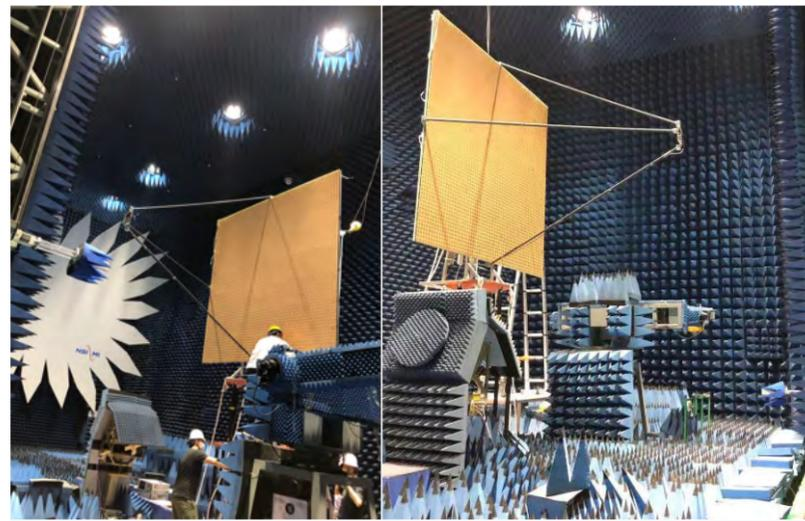
3m 大口径 2bit 相控阵天线平面近场测试
