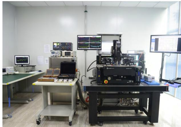
电子综合检测中心毫米波在片测试系统
