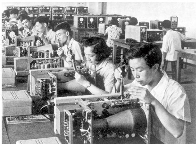
学生结合教学实验自制脉冲示波器
