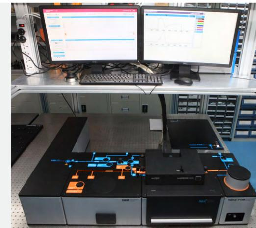
高分辨率散射式近场光学显微镜及纳米傅里叶红外变换光谱仪
